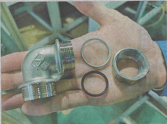
オーエヌ工業の「ナイスジョイント」。内側にゴムパッキン(中央下)を仕込んで管と接合し、ナット(右)で締め付ける。中央上は締め具合の確認のために付けるワッシャー(座金)
