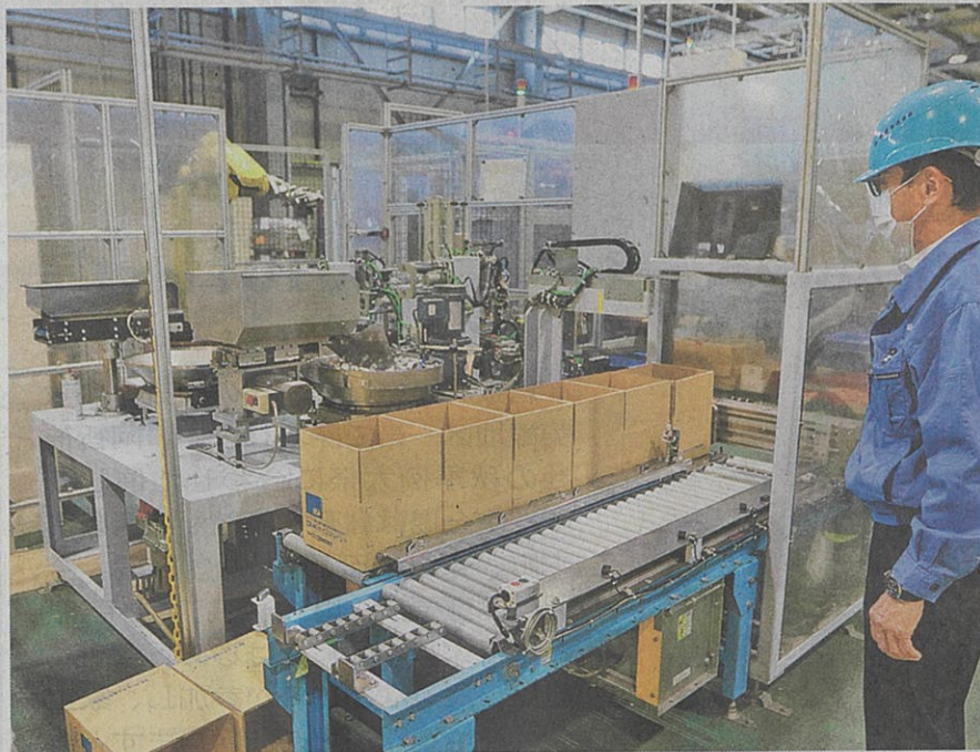
ステンレス製管継ぎ手の自動組み立て機。手作業による生産も含め、約400種類をラインアップする
