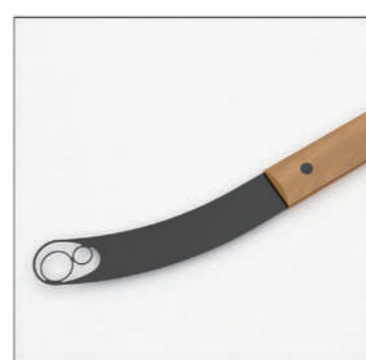
「ときこち kitchen」 初期デザイン案。 攪拌部の大きさ・長さが最適化されていない
